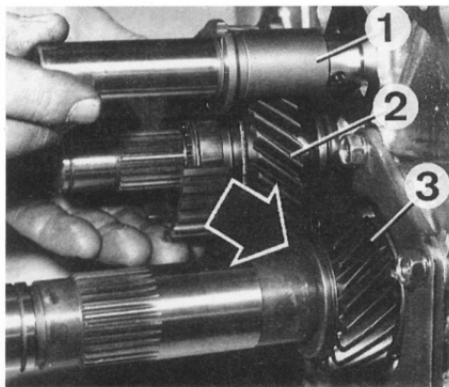
Montaggio ingranaggio 5ª - (3) orientare collare grande verso lato posteriore - (2) (freccia) Montaggio contemporaneo albero ingranaggio rinvio RM - (1) e ingranaggio folle 5ª
